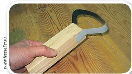
Понадобится деревянный держатель (можно просто подходящий удобный округлый брусок), металлическая пластина длиной около 25 см и шириной около 3 см (подойдет срез кровельного железа). Пластины сгибают по форме
