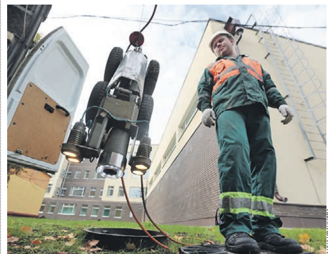
22 сентября 2015 года. Сотрудники Мосводостока используют специального робота для проверки сточных колодцев
